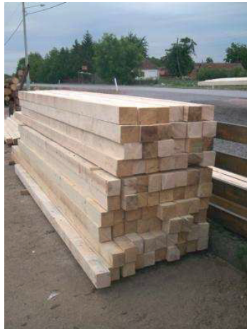
Сл.2.2 Складирање на греди
